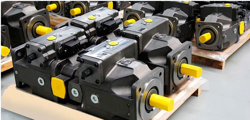
节能型液压元件-柱塞泵
