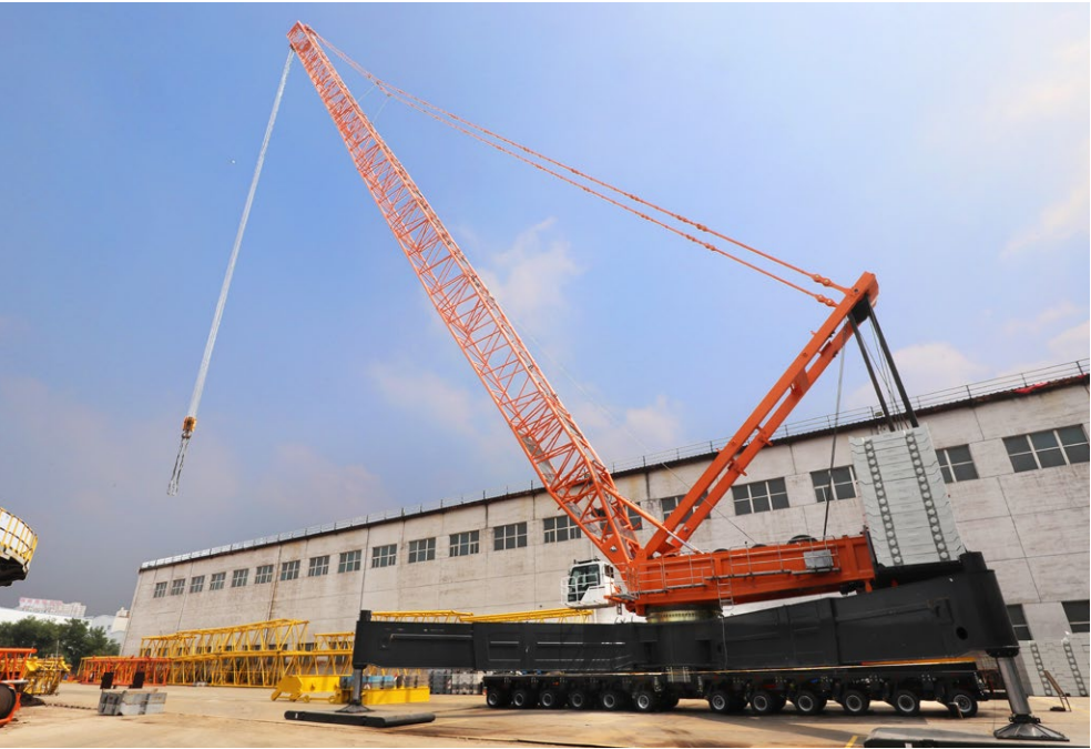
太重已成为全系列全领域的起重机设计研发制造基地，图为TZX1600多轴线桁架臂起重机
