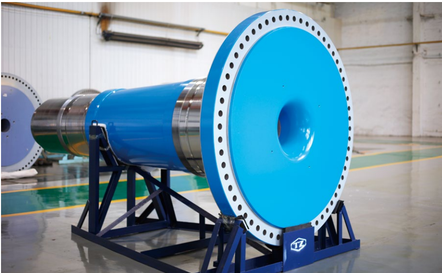
首创的“风电主轴锻件成形性一体化制造关键技术研究及应用”，实现传统水淬油冷工艺为纯水单介质冷却，避免油烟对环境的污染，获得2021年山西省科技进步二等奖
