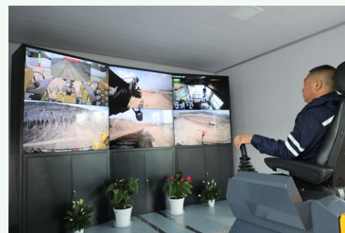
远程操作智能化挖掘机开发与应用项目
